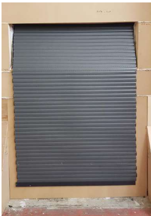
Vue du montage (côté émission) tablier déroulé
