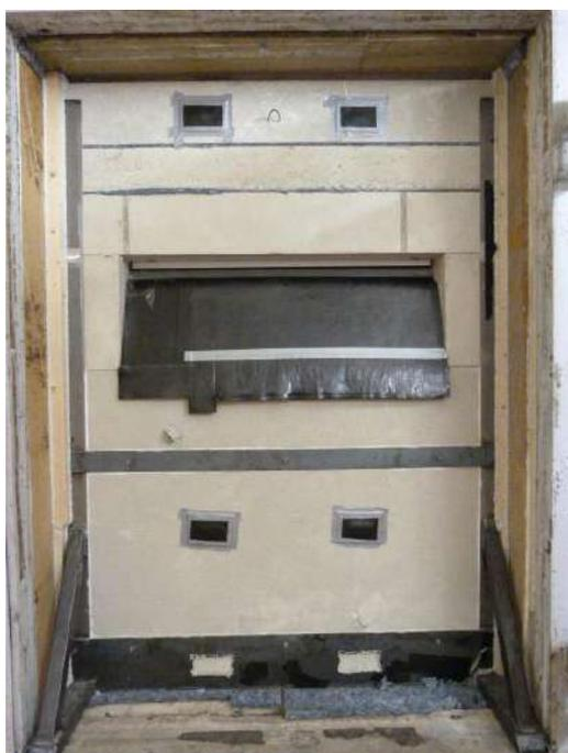
*Vue du montage (côté émission) tablier enroulé*
