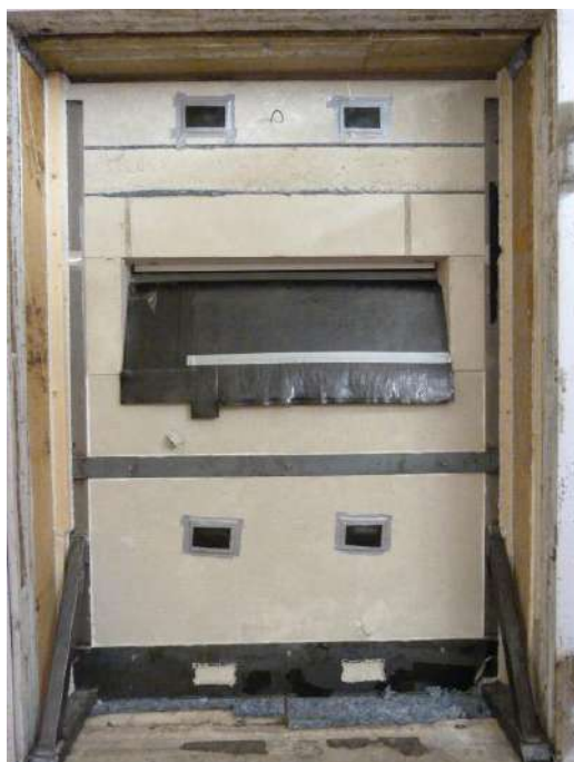
Vue du montage (côté émission) tablier enroulé
